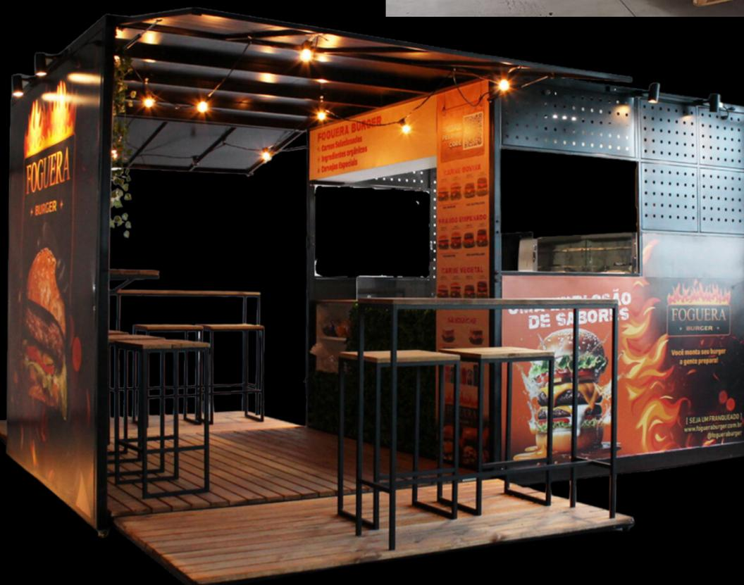
A loja montada ocupa pouco mais de 25m<sup>2</sup> e dimensionada para dois boxes de estacionamento como referência. Para transporte a loja é fornecida semi montada e ocupa apenas 2,7 metros de comprimento no baú de um caminhão de carga.
